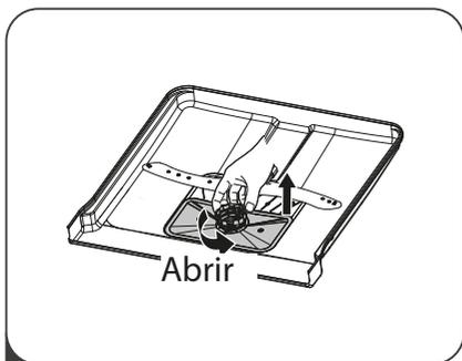
**1** Sujete el filtro para suciedad gruesa y gírelo hacia la izquierda para desbloquearlo. Eleve el filtro hacia arriba y hacia fuera para sacarlo del lavavajillas.
