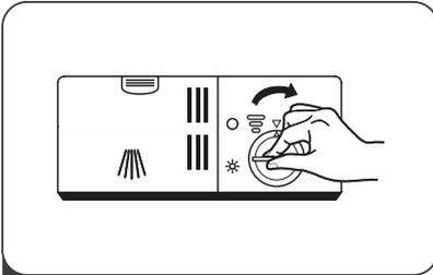
3 Cierre la tapa del depósito para el abrillantador girando en sentido a las agujas del reloj.
