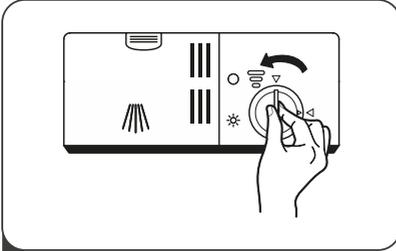
1 Quite la tapa del depósito para el abrillantador girando en sentido a las agujas del reloj.
