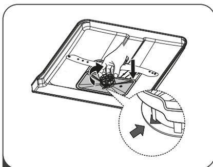
**4** Vuelva a montar los filtros en orden inverso, sustituya el encaje del filtro y gírelo hacia la derecha, hacia la flecha de cierre.
