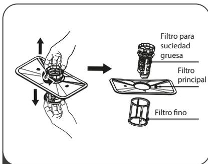
**2** El filtro fino se puede extraer tirando desde la parte inferior del conjunto del filtro. El filtro para suciedad gruesa se puede desacoplar del filtro principal girando suavemente las pestañas en la parte superior y tirando hacia fuera.
